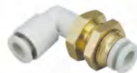
安装孔径=锁母螺纹名义尺寸+0.5
