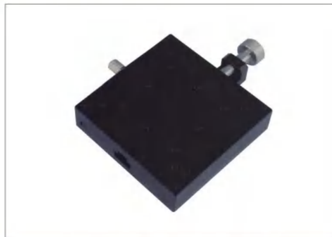
LWX100-Y: 由于客户需要在有水气的环境下使用，所以主体采用铝合金，内部配件均采用不锈钢
