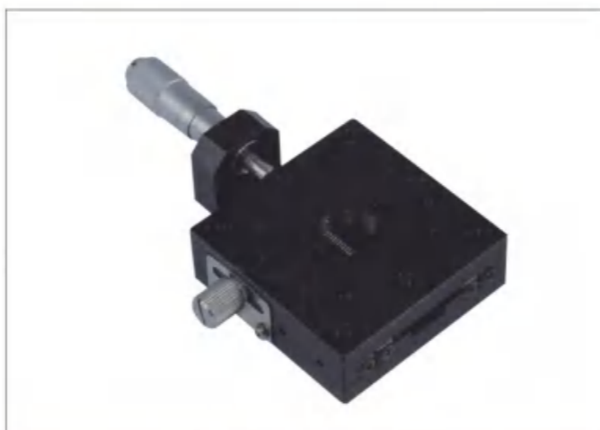
LX60-C-H20: 台面厚度20mm (标准为18mm)，并在台面与底部增加销子孔。
